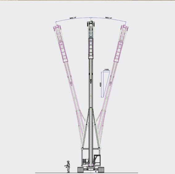
Existen piloteras y equipos de perforación con sistema de montaje en guía para ejecutar pilotes inclinados hasta 14° (4:1)
